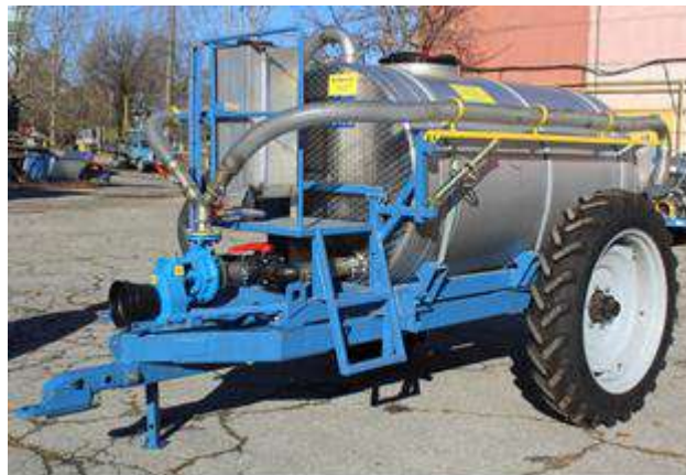
Fig.5. Modul-agregat pentru transportarea apei, montat în cadrul sistemului STMR-18-2000 1 – modul-șasiu; 2 – rezervor 2m 3 ; 3 –furtun de livrare; 4 –furtun de umplere a rezervorului; 5 – furtun de absorbție; 6 –arbore cardanic; 7 –pomă
