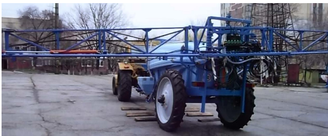
Figura 3 - Încercările dispozitivului de stabilizare a rampei cu utilizarea obstacolelor artificiale
