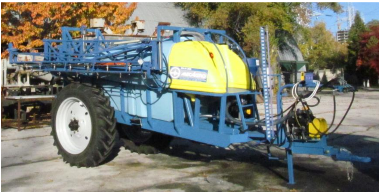
Figura 1 - Mașina de stropit tractată cu rampă STRU -24-3000
