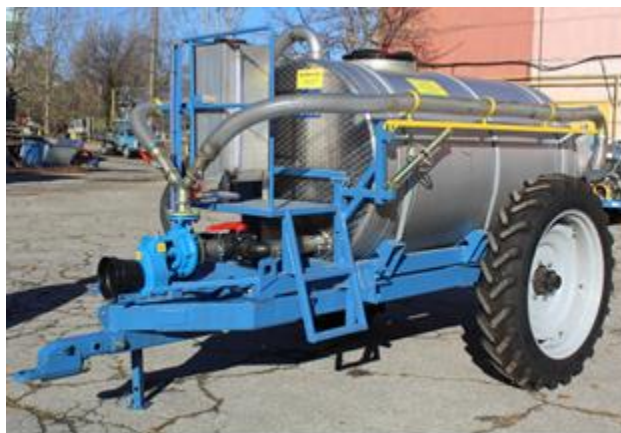
Fig.5. Modulul-agregat pentru transportarea apei, montat în cadrul sistemului STMR-18-2000 1 – modul-șasiu; 2 – rezervor 2m 3 ; 3 –furtun de livrare; 4 –furtun de umplere a rezervorului; 5 – furtun de absorbție; 6 –arbore cardanic; 7 –pompa
