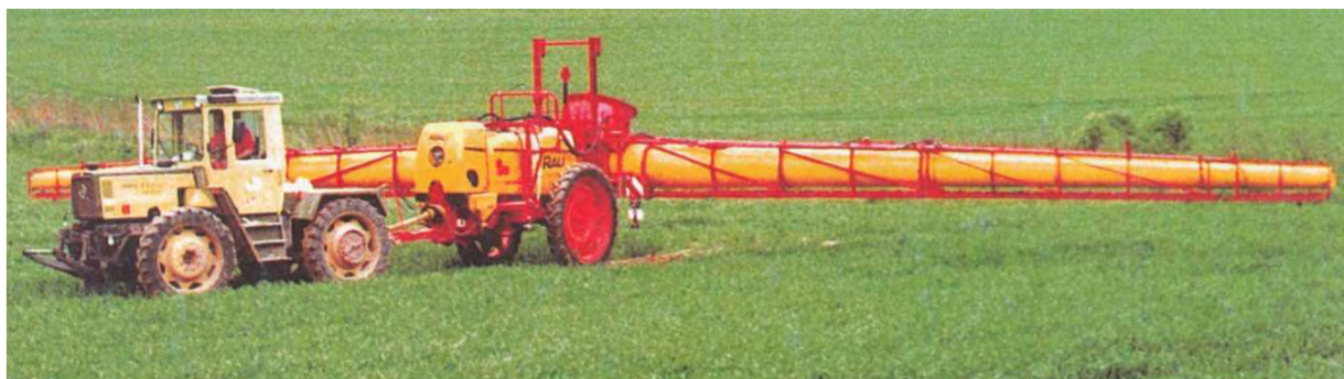
Fig. 5.4.3. Mașină de stropit cu rampă cu ventilator a firmei „RAU” (Germania).
