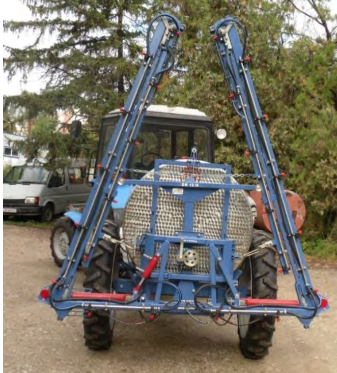
Fig. 5.3.3. Mașină de stropit STR-12H-2000 în stare de transport
