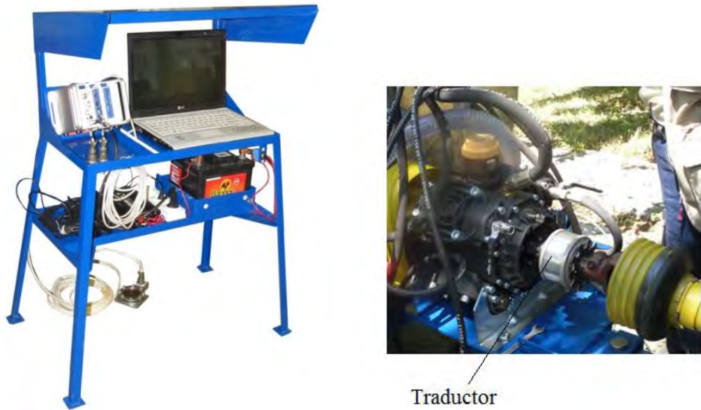
Fig. 5.2.1. – Stația tensometrică Q.brixx Gantner și procesul de testare a momentului de torsiune
