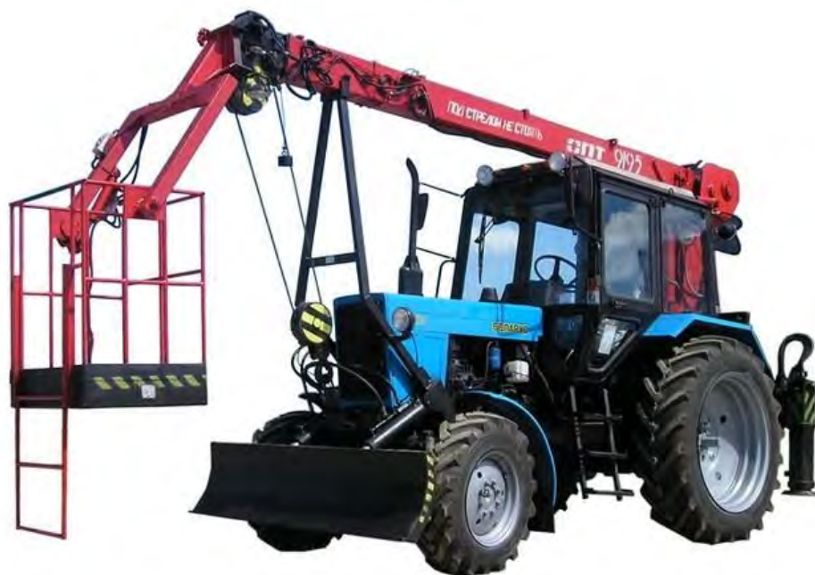
Fig.5.6.5. Macara-manipulator OPT-9195 cu instalare permanentă pe tractor Capacitate maximă 2250 kg Preț 415000 lei
