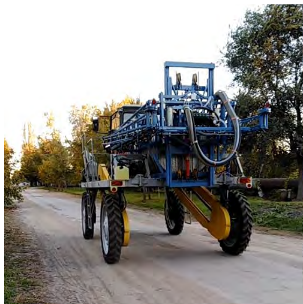
Fig.5.1.3. Mașina MSA-1700s supusă încercărilor pe drumurile publice
