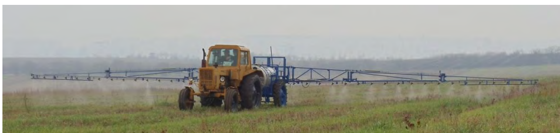
Fig. 5.3.2. Mașină de stropit STR-21-2000 în timpul lucrului
