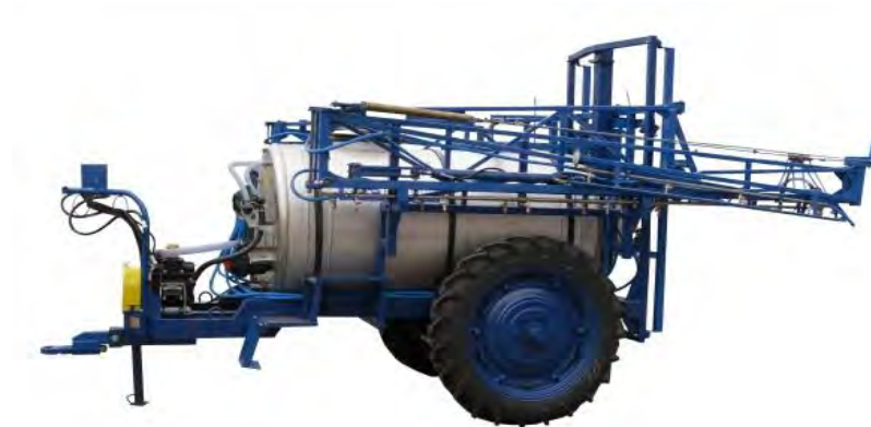
Fig. 5.3.1. Mașină de stropit STR-18-2000 în stare de transport
