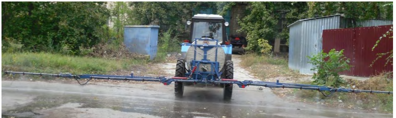
Fig. 5.3.4. Mașină de stropit STR-12H-2000 în stare de lucru
