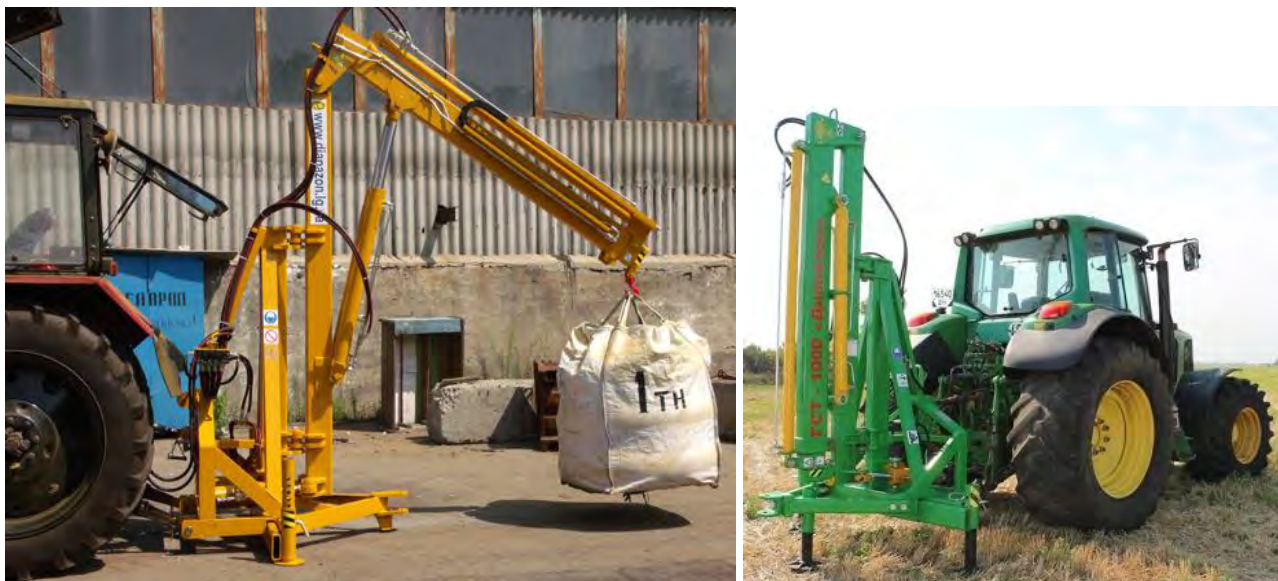
Fig.5.6.4 Manipulator GSTm-1000, cu braț rotitor, atașabil la tractor Capacitate maximă declarată 1500 kg Preț 150000 lei
